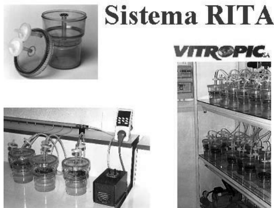
Figura 2. Sistema original RITA, de origen francés desarrollado por Vitropic S.A.
